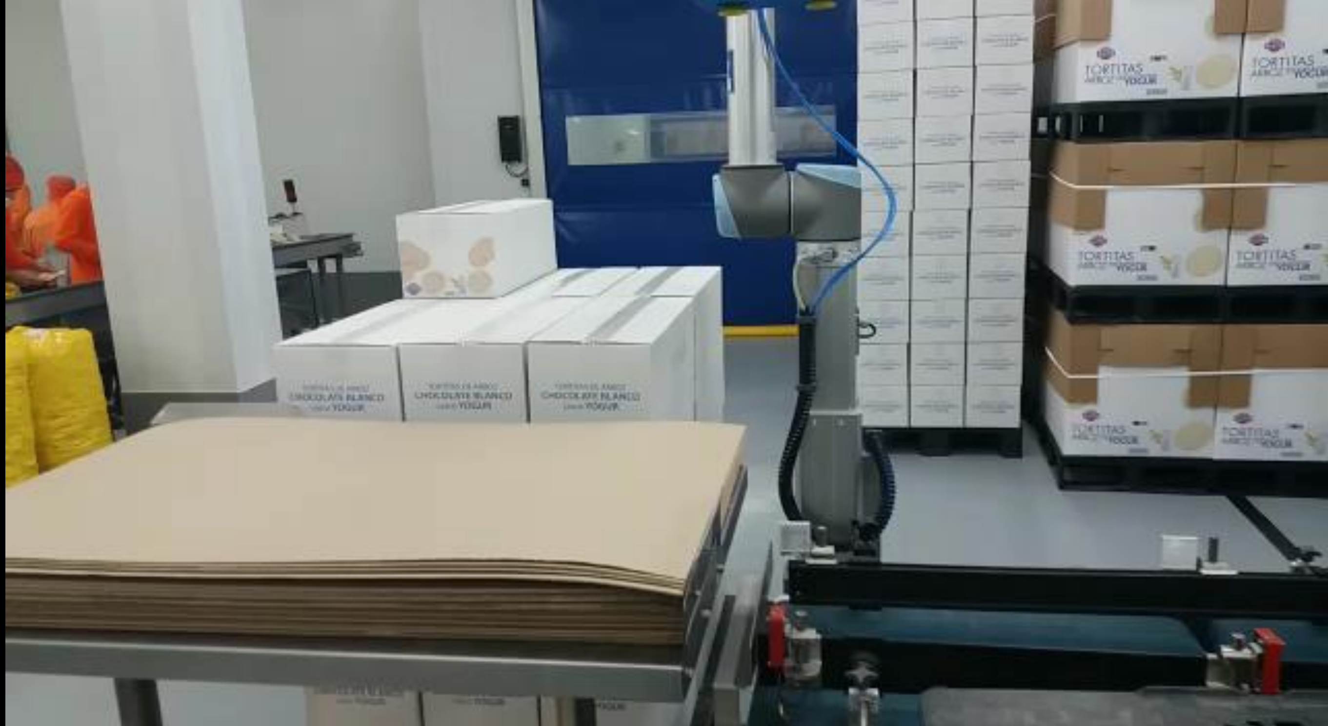
Paletizado final de línea Alimentación
